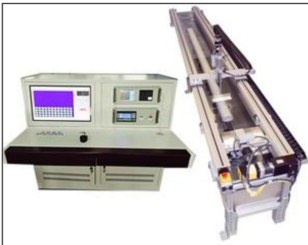
大型管、棒类超声 C 扫成像系统 BSN-C5088
